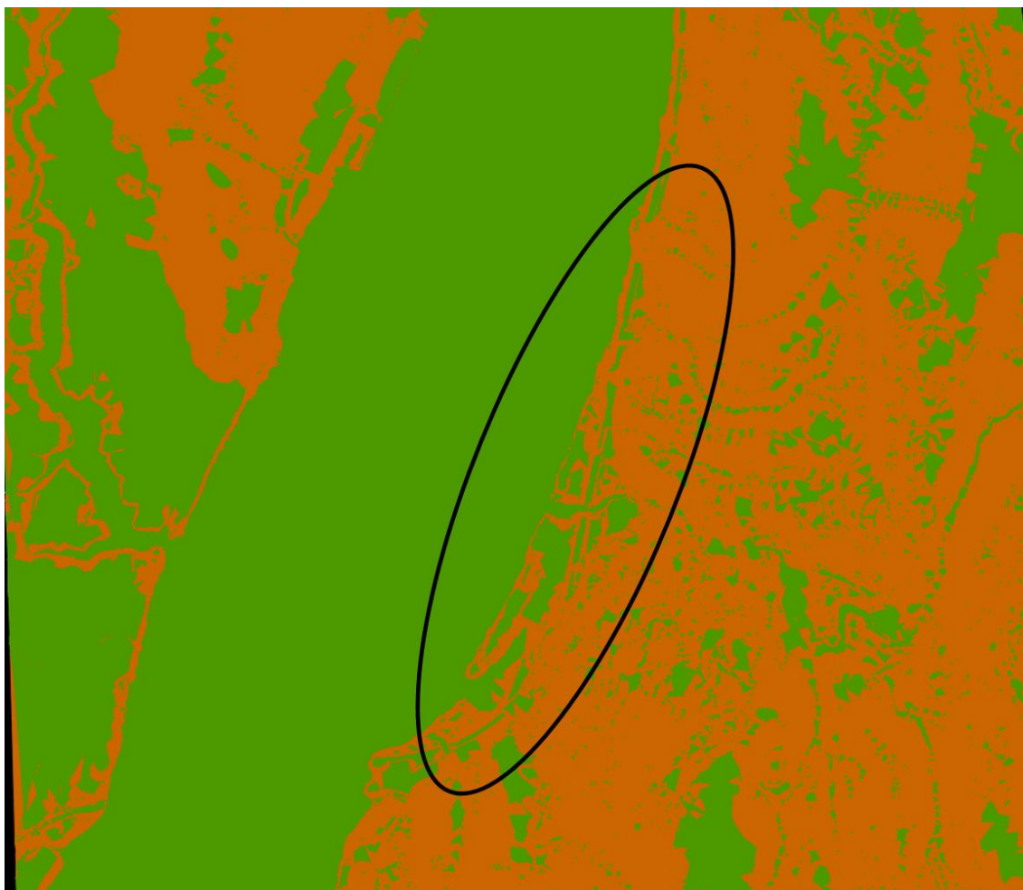
Figur 6: GIS-analyse av terrenghelning. Grønt illustrerer helning < 1:20, oransje illustrerer helning > 1:20. Prosjektområdet er omtrentlig markert med sort sirkel.
