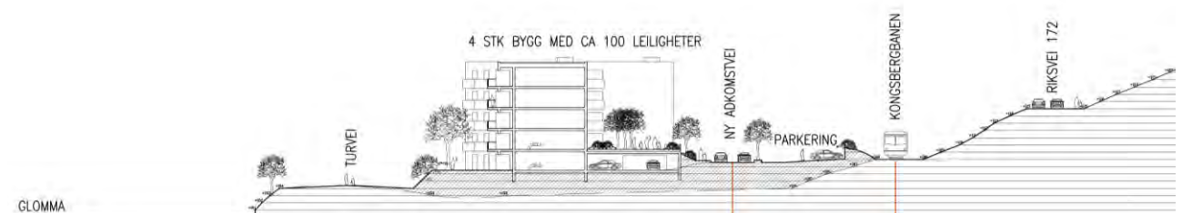
Figur 14-4: Snitt som viser mulig plassering av boliger vest for Svingen stasjon. Terrenget er fylt opp slik at bygget legges på minimumskoten for flom gitt i kommuneplanen, 106,5 moh. (utarbeidet av Arkitektene Dahl & Myrhol AS)
